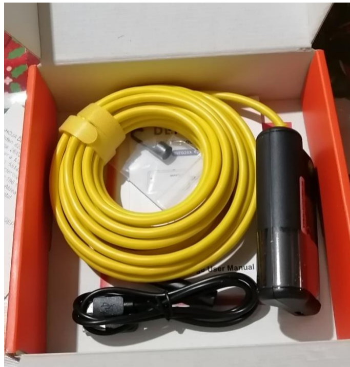
Ilustración 12 Camara endoscopica para la revision de cavidades/Endoscopic camera for inspecting cavities
